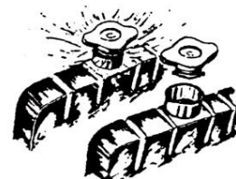
Rysunek 1-14 Odkręć osłonę chłodnicy
