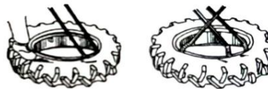
Rysunek 3-32 Regulacja rozstawu tylnych kół ciągnika
